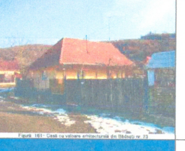
Clădire nr. 23 - clădire de locuit cu prispă laterală, goluri nealterate. Se observă stâlpii decorativi cât și capetele grinzilor. Încălțarea este realizată din țigla ceramică.
